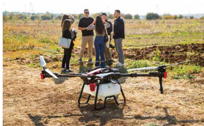
Το drone της XAG φτάνει ταχύτητες μέχρι και 13,8 μέτρα το δευτερόλεπτο και οι περισταλτικές του αντλίες είναι τοποθετημένες δύο-δύο δεξιά και αριστερά.
