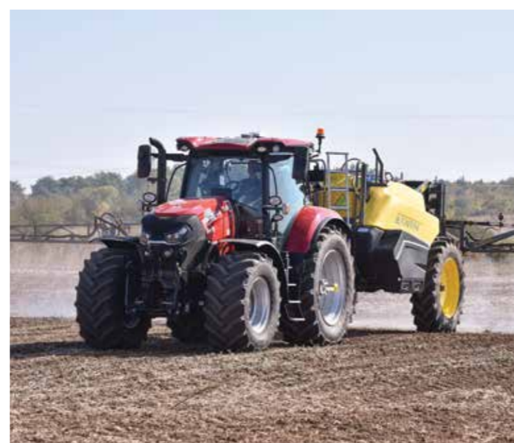
Με το δίκτυο RTK της P J Condellis SA και τον τμηματικό έλεγχο επιτυγχάνεται εξοικονόμηση φυτοπροστατευτικών της τάξεως 15-20%.
